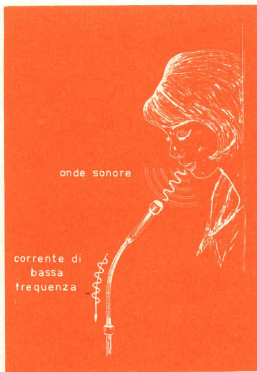
Fig. 26 - Trasformazione di un'onda sonora in una corrente alternata avente la stessa ampiezza e frequenza mediante un microfono.
